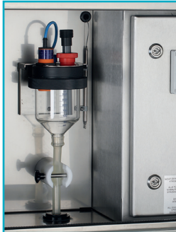
Pneumatisches Dosiersystem kapazitiver Sensor mit Ex-Zulassung
